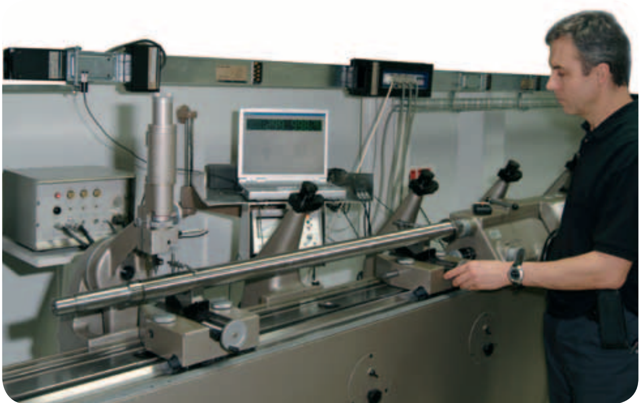
导程误差控制干涉试验台
