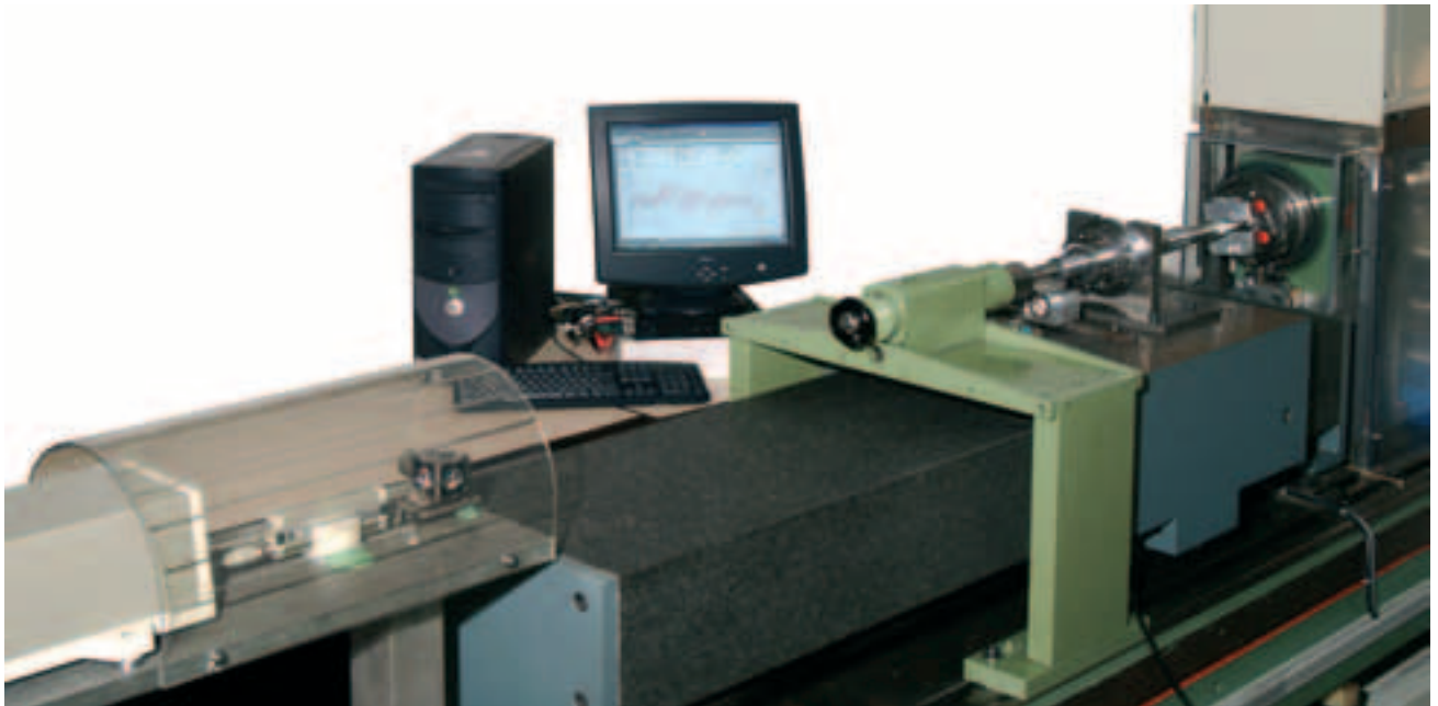
单转内完整组件的导程精度控制
